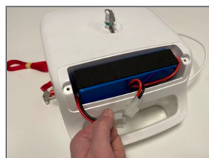
6. Setzen Sie die neue Batterie ein und schließen Sie sie an.
