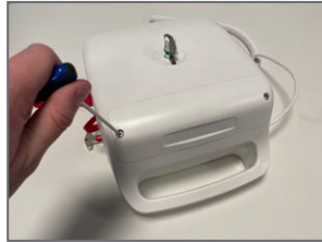
2. Entfernen Sie die Batterieabdeckung mit dem Inbusschlüssel.
