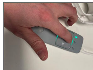
6. Testa handkontrollen. Montera den övre kåpan.
