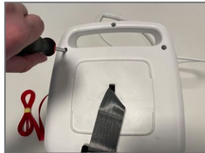
5. Entfernen Sie die Schrauben der unteren Abdeckung
