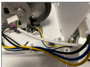
3. Schuif de kabelhouder en zet hem vast.
