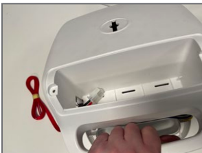
7.1. Entfernen Sie die obere Abdeckung (achten Sie auf die Kabel und die Anschlüsse)
