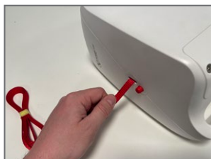
1. Aktivieren Sie Notstopp, indem Sie am roten Band ziehen.
