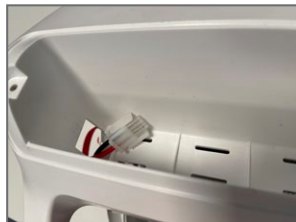
7.2. Verwijder de bovenkap (let op de kabels en de connectoren)
