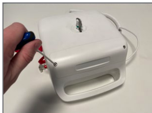
2. Ta bort batteriluckan med insexnyckeln.
