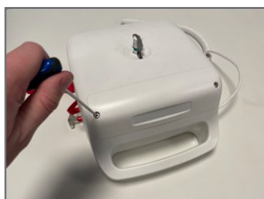
2. Ta bort batteriluckan med insexnyckeln.
