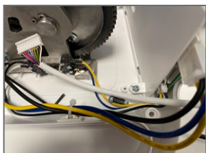
4. Se till att kabeln och gummitätningen sitter på plats.
