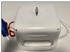
8. Montera batteriluckan och skruva fast den.
