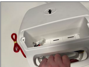
7.1. Verwijder de bovenkap (let op de kabels en de connectoren)
