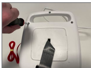
5. Ta bort skruvarna från den undre kåpan.
