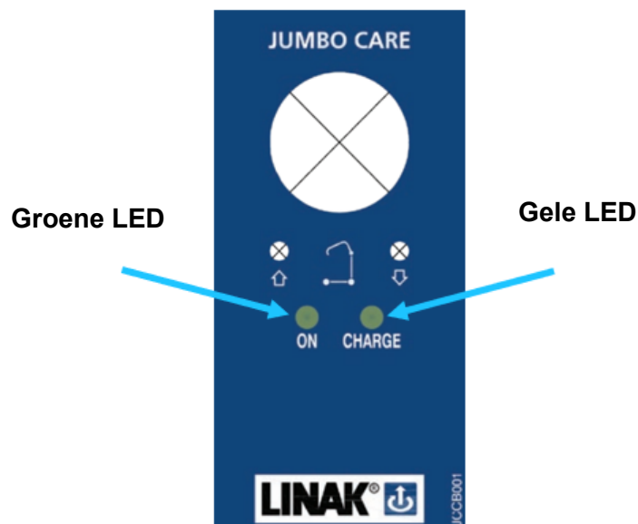
Afbeelding 19 – LED – locatie op de besturingskast
