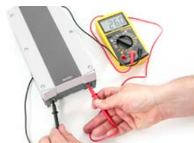
Überprüfung der Spannung der Batterie
