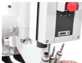
Überprüfung der Kabelverbindung
