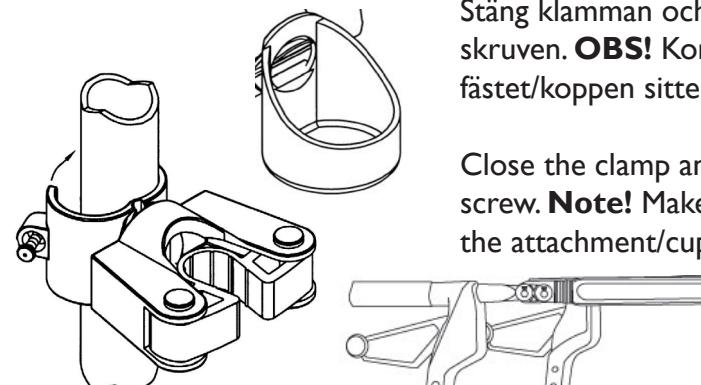
Stäng klamman och skruva åt skruven. **OBS!** Kontrollera att fästet/koppen sitter fast.
