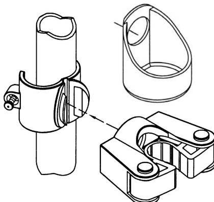
Innan klamman stängs, ta fästet/koppen och för in klammans griptänder genom hålet i fästet/koppen. Passa på att vrida den i önskad läge.
