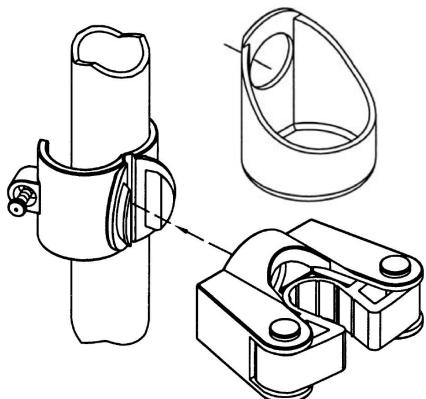
Avant de fixer la pièce supérieure en place, presser doucement les extensions de préhension avec une pince et insérer dans le trou de fixation inférieure / tasse. Tourner en position préférée.
